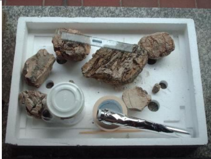
Figura 1: attrezzatura necessaria per la realizzazione di stampi in gomma siliconica: rocce, gomma e reagente, carta stagnola e nastro.
